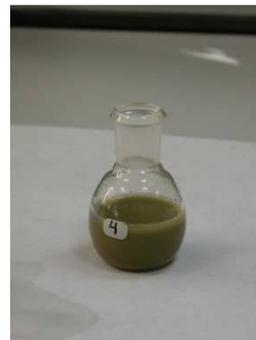
Una vez introducido el polvo, agita circularmente el picnómetro para que el material se moje bien y se eliminen las burbujas de aire atrapadas entre las partículas de polvo.
