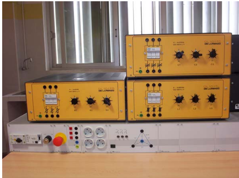
Figura 6. Protecciones, fuentes de alimentación en alterna, cargas resistivas, inductivas y capacitivas necesarias para la realización de la práctica.
