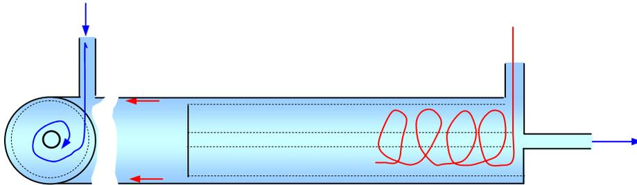
Figura 67. Instalación basada en el efecto torbellino.
