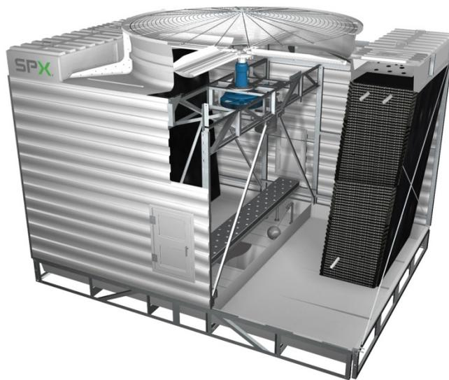
Figura 123. Torre de refrigeración de flujo cruzado con tiro inducido (Marca SPX, Modelo MARLEY NX).
