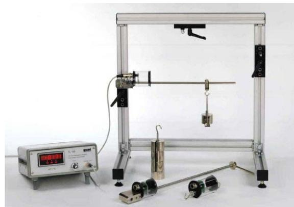
El objetivo de la práctica es comprobar la ley de Hooke tanto en un experimento de tracción de un material como en el de la deflexión de una barra cargada en su extremo.
