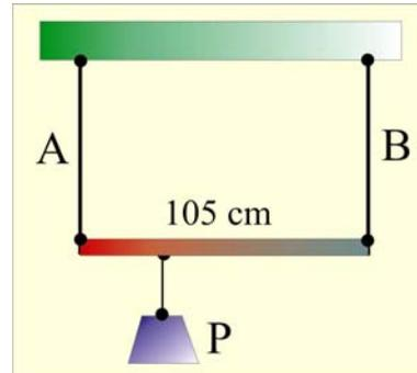
14. Una barra de 1,05 m de longitud, cuyo peso es despreciable, está sostenida en sus extremos por hilos A y B de igual longitud tal y como muestra la figura. La sección recta de A es de  $1 \text{ mm}^2$  y la de B de  $2 \text{ mm}^2$  y los respectivos módulos de Young son  $2,4 \times 10^{11} \text{ Nm}^{-2}$  y  $1,6 \times 10^{11} \text{ Nm}^{-2}$ . ¿En qué punto de la barra hay que colocar un peso P para producir: a) igual esfuerzo en A que en B; b) igual deformación unitaria en A y B?
