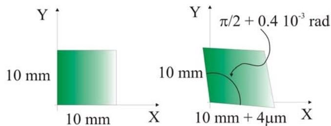
21. Para la deformación de la figura se pide: a) Tensor de deformaciones. b) Dibuje el círculo de Mohr y determine las deformaciones principales con ayuda del mismo. c) Calcule con ayuda del círculo las deformaciones normal y tangencial según los planos de máxima deformación tangencial y de un plano que forma 60° con el eje X1.
