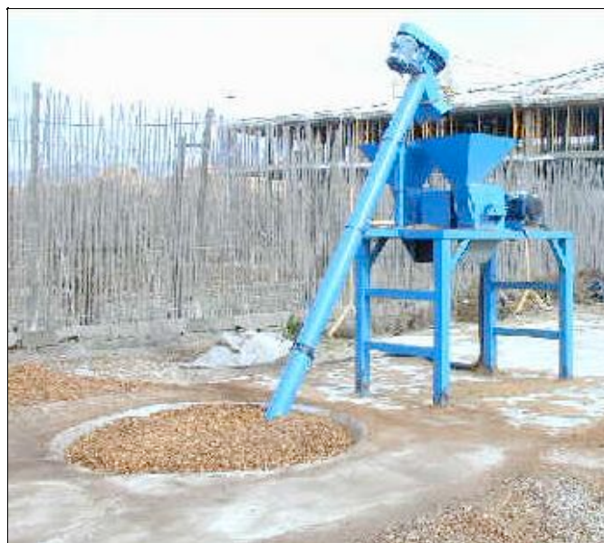
Molino triturando residuos en la planta piloto
