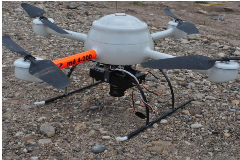
Imagen 2. Md4-200 de Microdrones, vehículo aéreo no tripulado empleado para la captura de imágenes. En la parte inferior de la carcasa central se observa la cámara empleada para la toma de imágenes.
