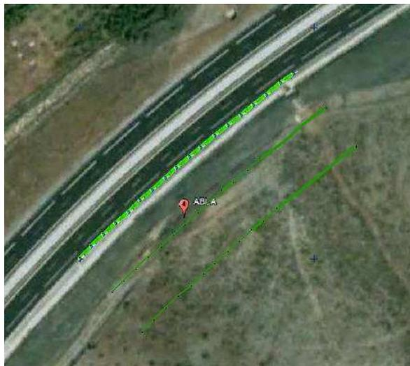
Fig. 2.1.4. Planificación del vuelo (3 pasadas)
