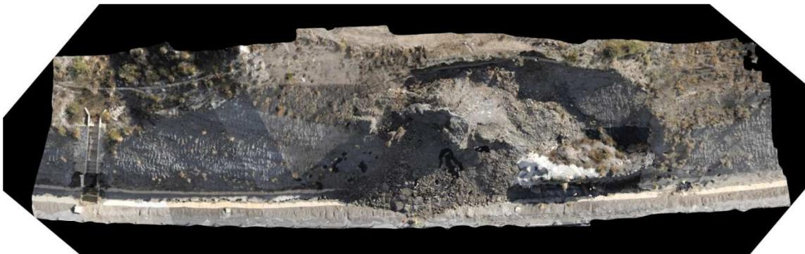
Fig. 2.2.5. Ortofoto del talud exportado del proyecto fotogramétrico
