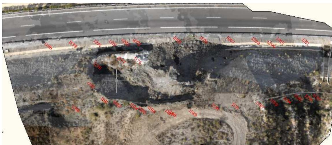
Fig. 2.1.5. Puntos de control obtenidos "in situ" con GPS
