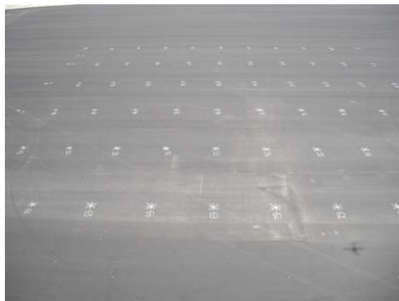
Foto 2.3.- Patrón de calibración realizado para la calibración en campo.
