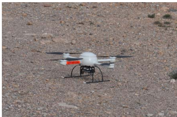
Foto 2.1.- Detalle de la aeronave utilizada (Dron md 4-200) con la cámara Pentax Optio A40 acoplada a la base de la misma.
