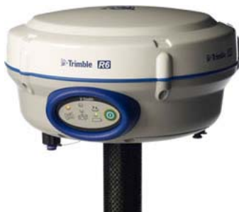
Foto 2.1.- Detalle del GPS Trimble R6 utilizado para realizar el levantamiento topográfico.
